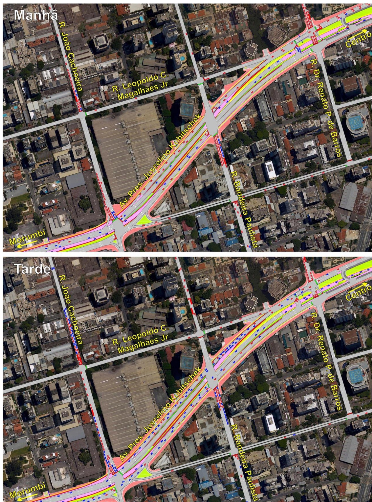
Figura 4.15a: Resultado da Microssimulação - Projeto Proposto Boulevard JK - Com Túnel Previsto Parte A
