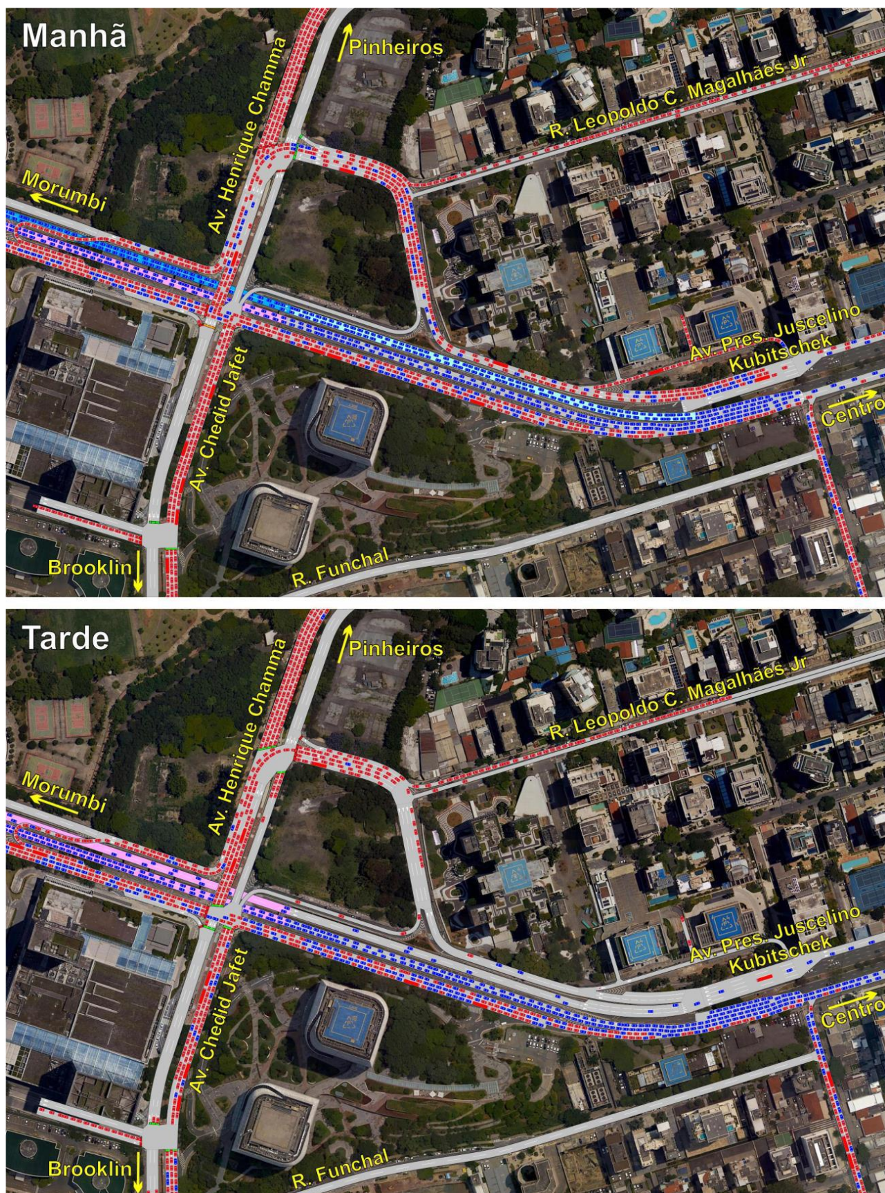
Figura 4.6c: Resultado da Microsimulação - Projeto Inicial Boulevard JK - Sem Túnel Previsto Parte C
