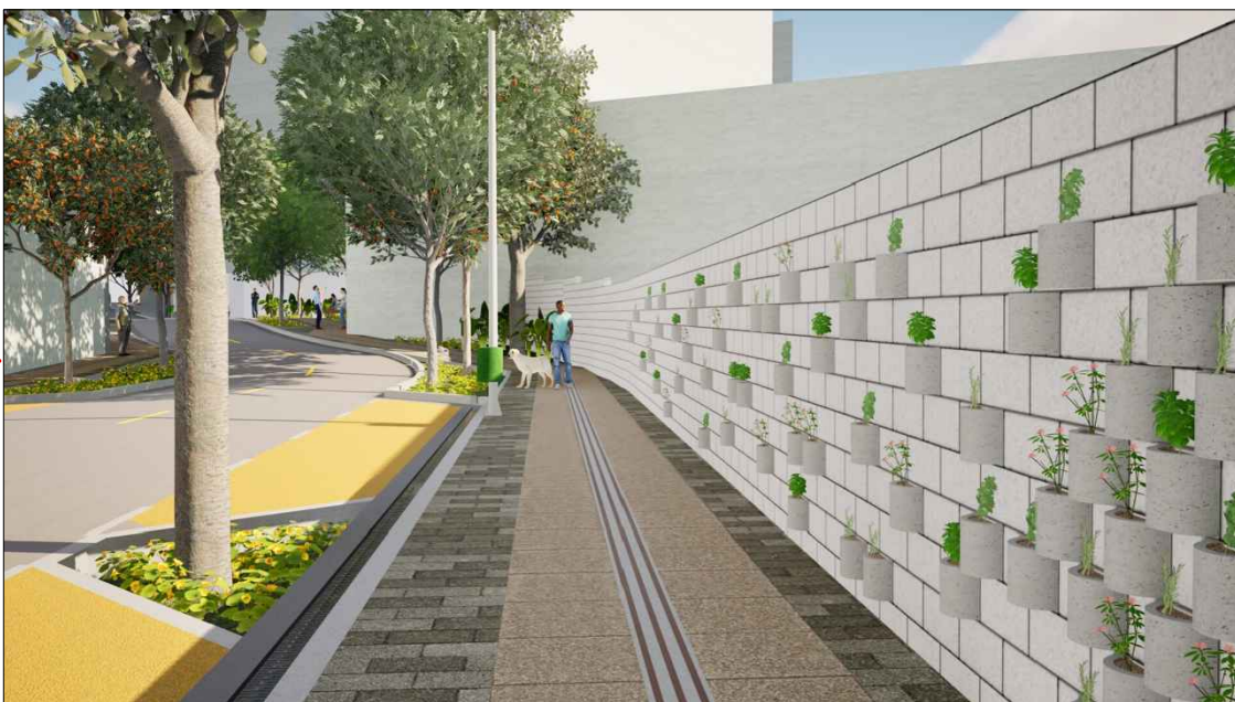
CALÇADA EM PLACA CIMENTÍCIA COM ACESSIBILIDADE
