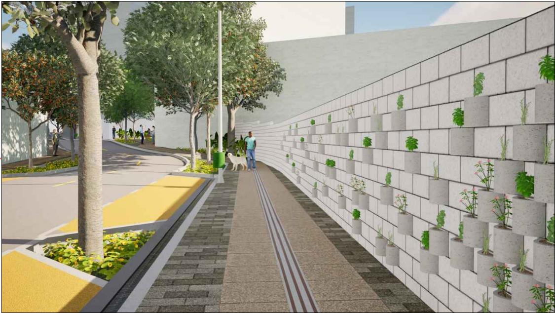
CALÇADA EM PLACA CIMENTÍCIA COM ACESSIBILIDADE
