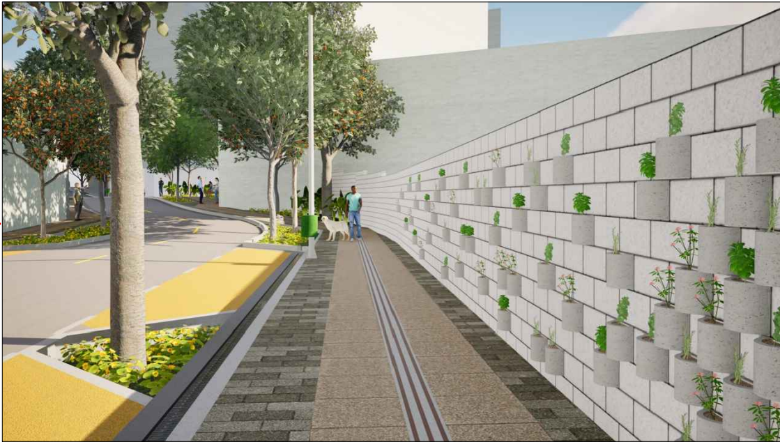
CALÇADA EM PLACA CIMENTÍCIA COM ACESSIBILIDADE
